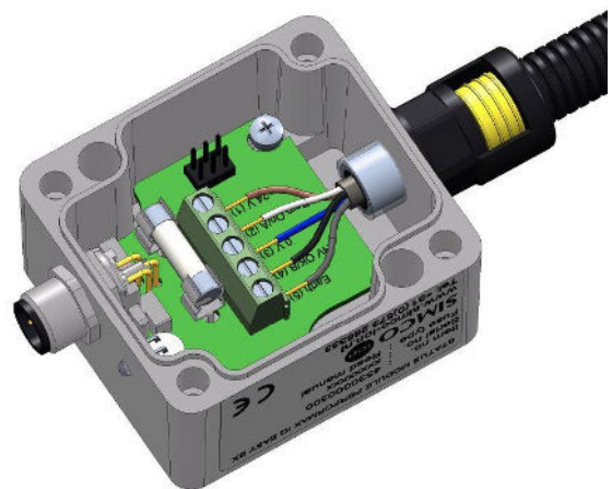
Abbildung 5.8.2.8: Anschluss Verschraubung am Modul
